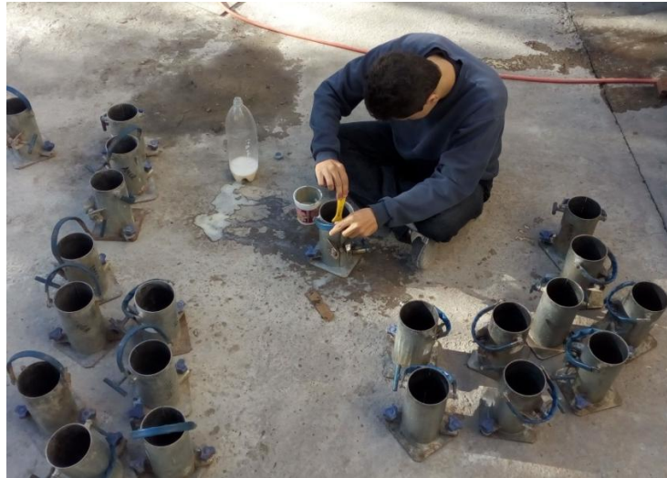
Figura 22 – Aplicação do desmoldante nos corpos de prova.
