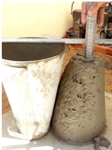
Figura 34 – Slump test do concreto com cimento CP V-ARI.
