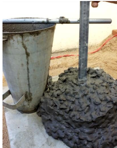
Figura 31 – Slump test do concreto com cimento CP II-F-32.
