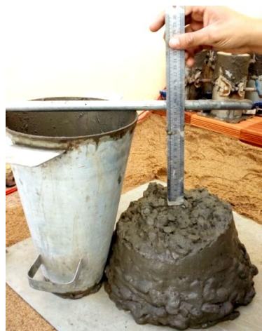
Figura 32 – Slump test do concreto com cimento CP II-Z-32.
