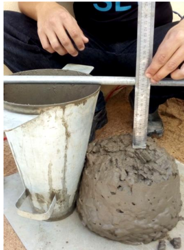
Figura 33 – Slump test do concreto com cimento CP IV-32-RS.
