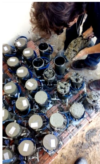
Figura 23 – Moldagem e identificação dos corpos de prova.
