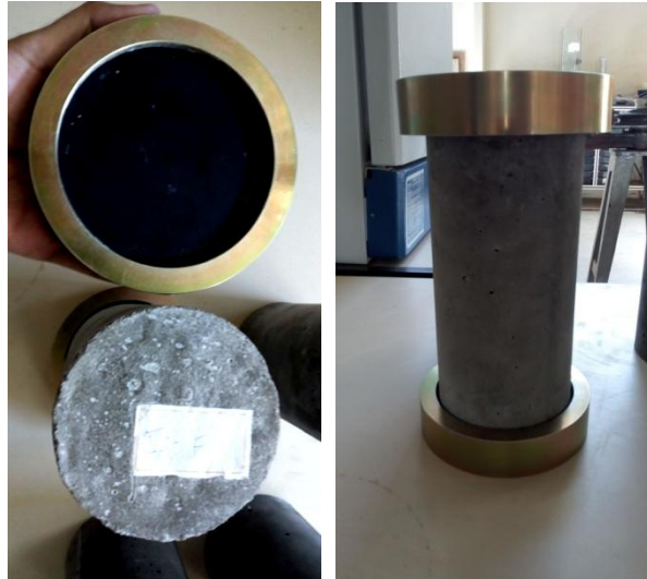
Figura 26 – Capeamento do corpo de prova com neoprene.
