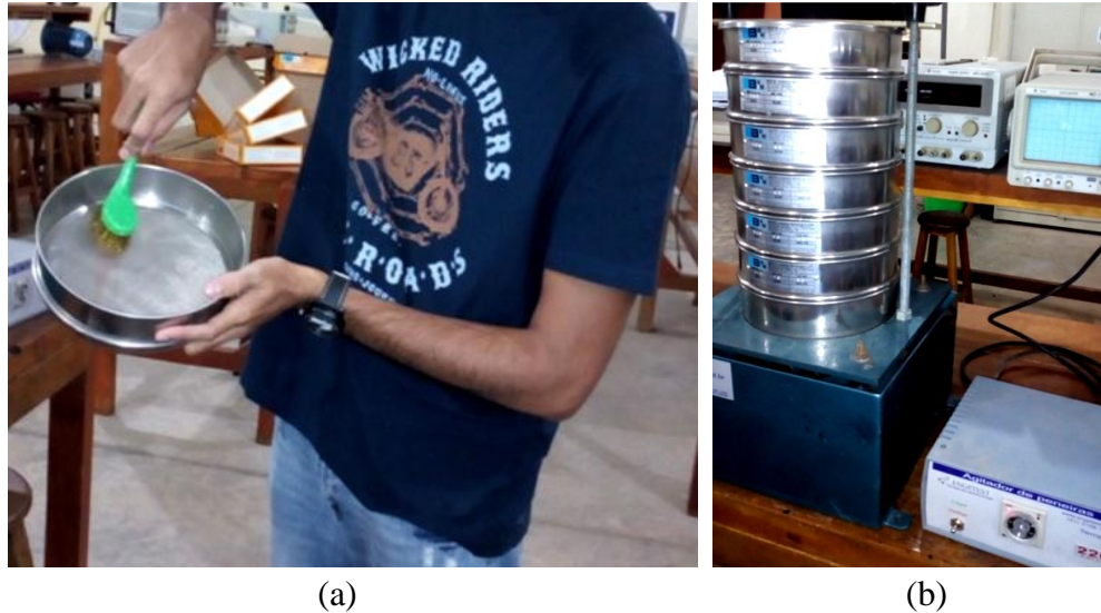
Figura 18 – Peneiras de ensaio granulométrico: a) Limpeza; b) Disposição sobre o agitador mecânico.
